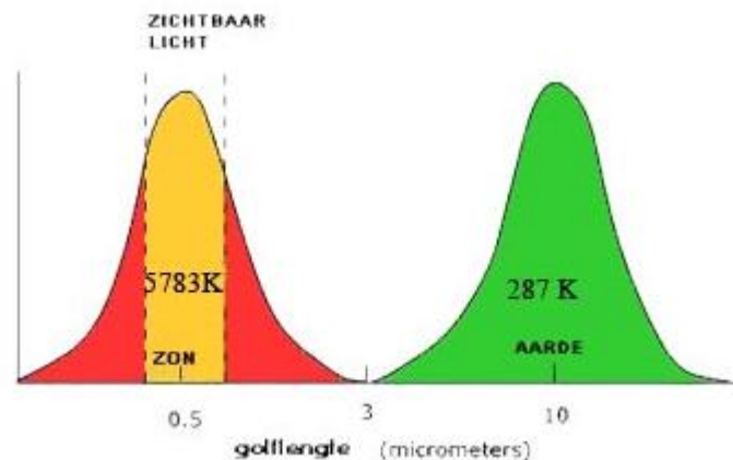
Fig. 16 Het spectrum van de zon en van de aarde
