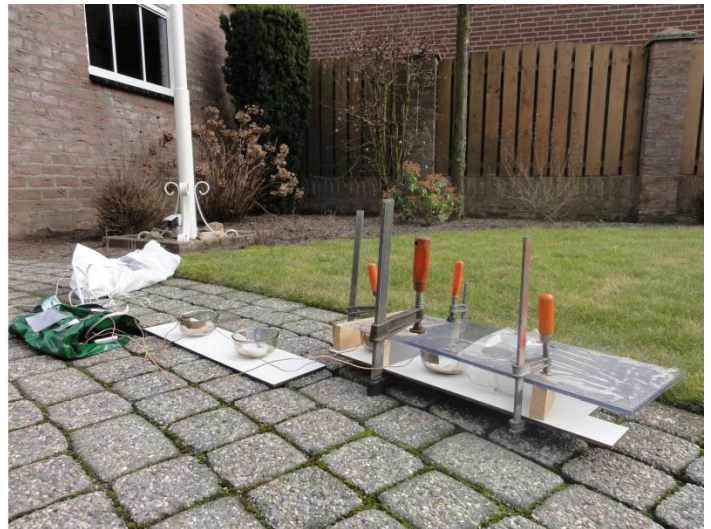
Fig. 40 Dit zijn de opstellingen van beide practica. Links is een poging tot het uitvoeren van practicum 1 te zien. Tijdens dit proefpracticum regende het. Links in het plaatje is de witte plastic zak te zien waarin de Ulab zat, zodat hij niet nat werd. Rechts is het plaatje te zien van practicum 2
